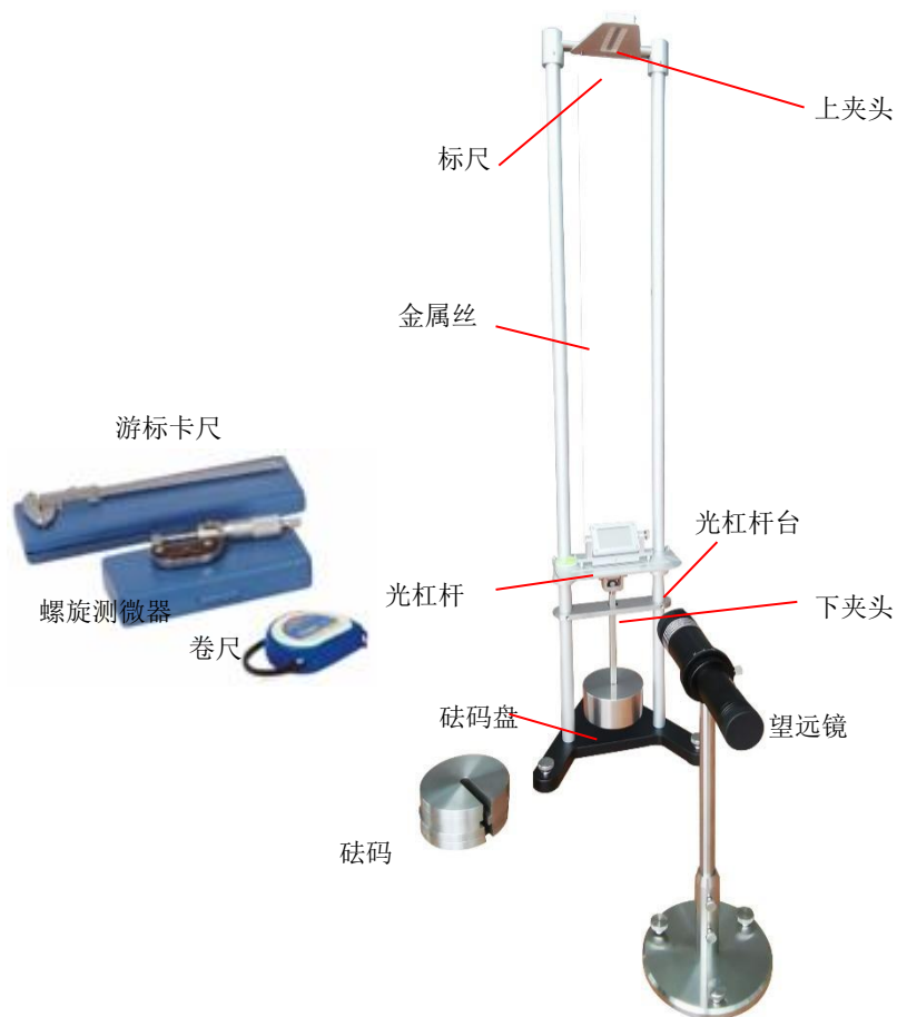
图 4-11 近距转镜杨氏模量仪
